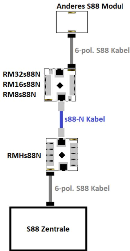
Abbildung 4: Anschluss an andere S88 Module mit S88 Kabel
